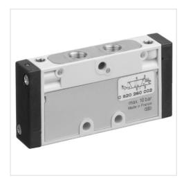
Bauart Schieberventil Betätigung pneumatisch Vorsteuerung extern weich dichtend Dichtprinzip 600 l/min Durchflusswert Qn Betriebsdruck min./max. -0,9 ... 10 bar Steuerdruck min./max. 2,5 ... 10 bar -10 ... 50 °C Umgebungstemperatur min./max. -10 ... 50 °C Mediumstemperatur min./max. Druckluft Medium Max. Partikelgröße 5 µm Ölgehalt der Druckluft 0 ... 5 mg/m<sup>3</sup> Montage auf Sammelanschlussleiste P-Leiste Anzugsmoment der Befestigungsschraube 2 Nm Gewicht 0,113 kg
