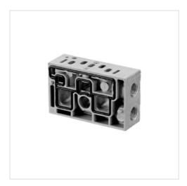
ISO 15407-1 Normen Betriebsdruck min./max. 0 ... 16 bar Umgebungstemperatur min./max. -15 ... 70 °C -15 ... 80 °C Mediumstemperatur min./max. Medium Druckluft Richtung pneum. Anschluss (2,4) Seitlich Gewicht 0,15 kg
