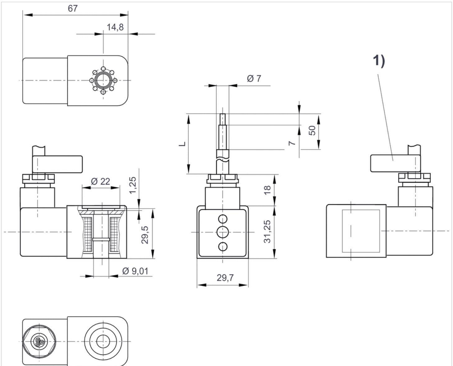
L = Kabellänge 1) Kabelkennzeichnungsband mit Seriennummer
