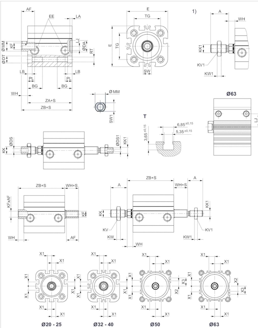
S = HubT = Ansicht für Sensornut 1) Außengewinde Benutzen Sie unseren Internetkonfigurator, um Varianten mit Außengewinde zu bestellen.
