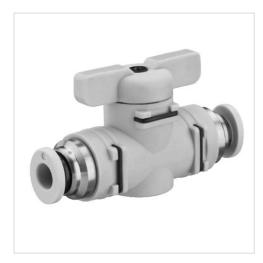
Bauart Kugelventil Betriebsdruck min./max. -0,95 ... 10 bar 0 ... 60 °C Umgebungstemperatur min./max. Mediumstemperatur min./max. 0 ... 60 °C Medium Druckluft Gewicht Siehe Tabelle unten
