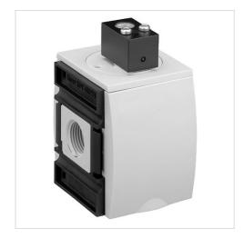
**Bauart** Sitzventil, verblockbar Dichtprinzip weich dichtend 0 ... 16 bar Betriebsdruck min./max. Steuerdruck min./max. 2,5 ... 16 bar Umgebungstemperatur min./max. -10 ... 50 °C -10 ... 50 °C Mediumstemperatur min./max.
