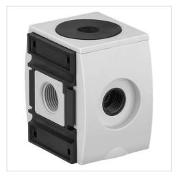
Bauart Mitteneinspeisung, verblockbar Einbaulage Beliebig 0 ... 16 bar Betriebsdruck min./max. -10 ... 50 °C Umgebungstemperatur min./max. Mediumstemperatur min./max. -10 ... 50 °C Druckluft, neutrale Gase Medium
