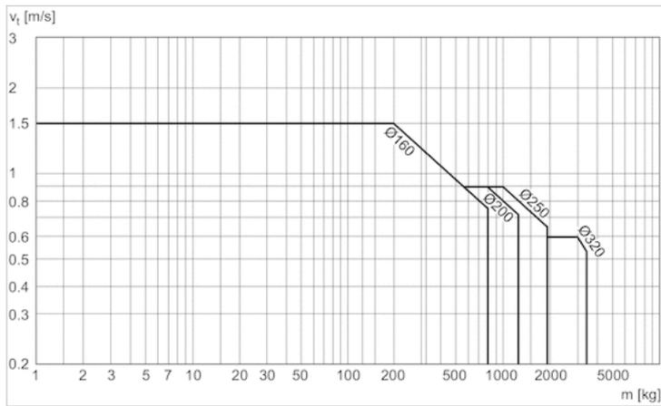
$v$  = Kolbengeschwindigkeit [m/s]
