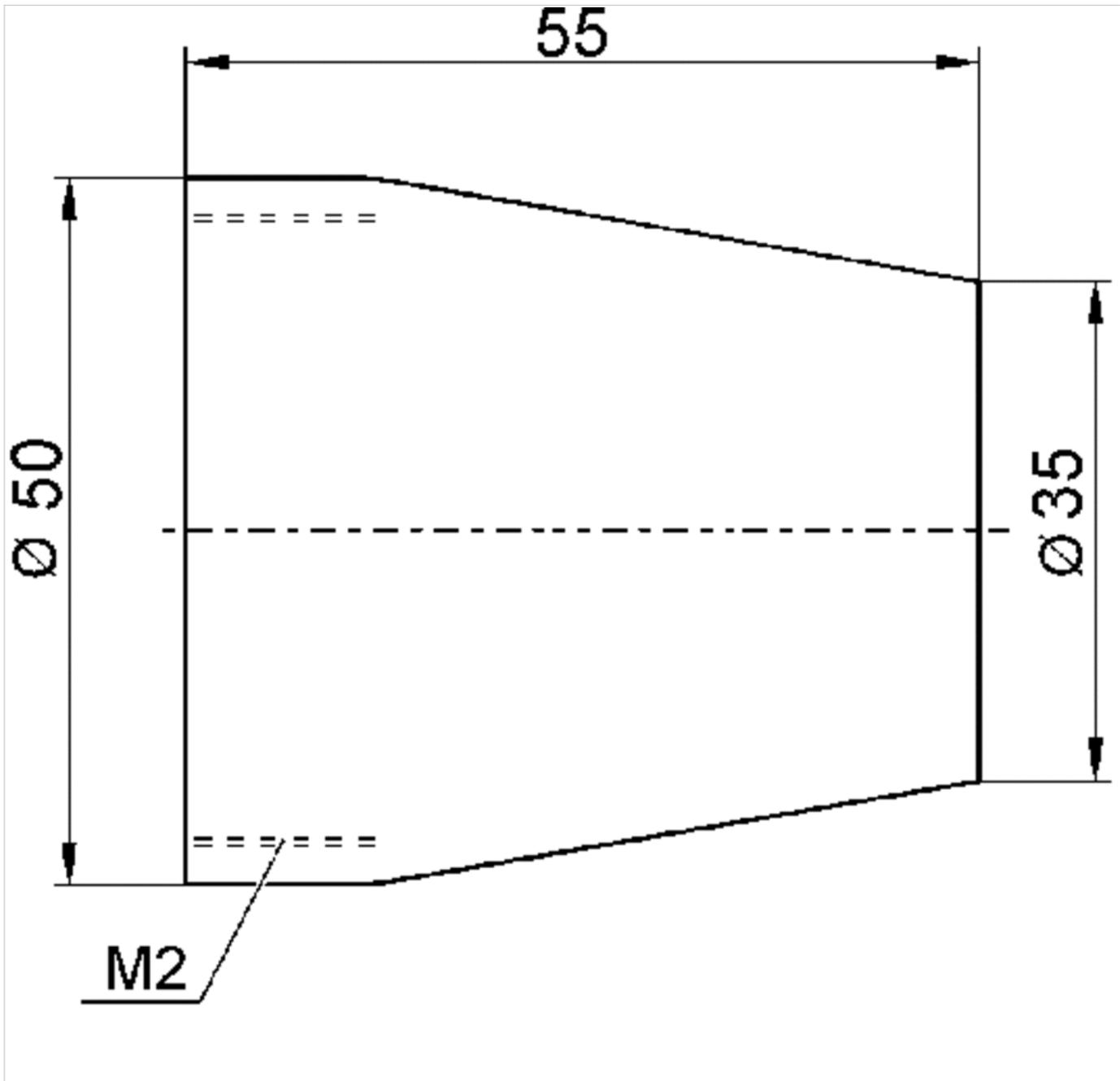
Die Schutzkappe ist auf beiden Seiten der Kupplung montierbar.
