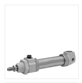
Innengewinde Druckluftanschluss Betriebsdruck min./max. 3 ... 10 bar -20 ... 70 °C Umgebungstemperatur min./max. -20 ... 70 °C Mediumstemperatur min./max. Medium Druckluft 50 µm Max. Partikelgröße Ölgehalt der Druckluft 0 mg/m<sup>3</sup> Druck zur Bestimmung der Kolbenkräfte 6.3 bar
