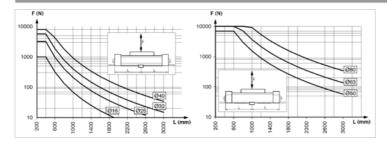
Max. Stützlänge L [mm] als Funktion von F [N] bei 0,5 mm Durchbiegung
