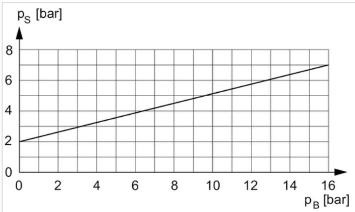
Minimaler Steuerdruck in Abhängigkeit vom Betriebsdruck  $p_S =$  Steuerdruck  $p_B =$  Betriebsdruck
