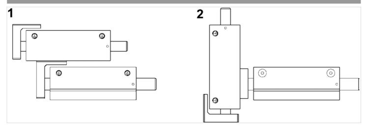
Der GPC-TL kann direkt auf die Frontplatte des nächst größeren Standard-GPC in radialer Richtung und des nächst größeren GPC-TL in axialer Richtung montiert werden.
