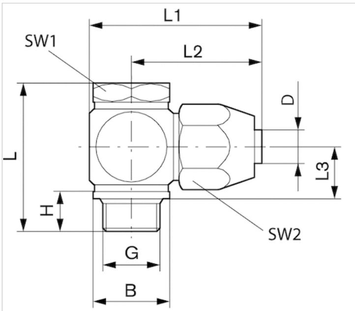
für Kunststoffschlauch mit Gewebeeinlage
