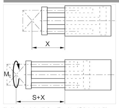
X = Abstand zwischen Kraftangriffspunkt und ZylinderdeckelM = max. zulässiges DrehmomentS = Hub
