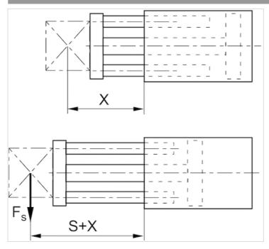
X = Abstand zwischen Kraftangriffspunkt und ZylinderdeckelF~S~= SeitenkraftS = Hub
