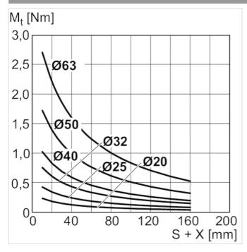
X = Abstand zwischen Kraftangriffspunkt und ZylinderdeckelM = max. zulässiges DrehmomentS = Hub
