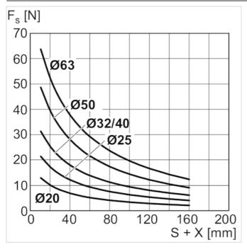
X = Abstand zwischen Kraftangriffspunkt und ZylinderdeckelF~S~= SeitenkraftS = Hub
