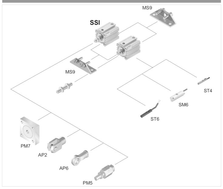
Benutzen Sie unseren Internetkonfigurator, um Varianten mit Außengewinde zu bestellen.HINWEIS: Diese Übersichtzeichnung dient zur Orientierung, an welcher Stelle die unterschiedlichen Zubehörteile am Zylinder befestigt werden können. Dazu wurde die Darstellung vereinfacht. Eine konkrete Ableitung maßlicher Gegebenheiten ist deshalb nicht zulässig.
